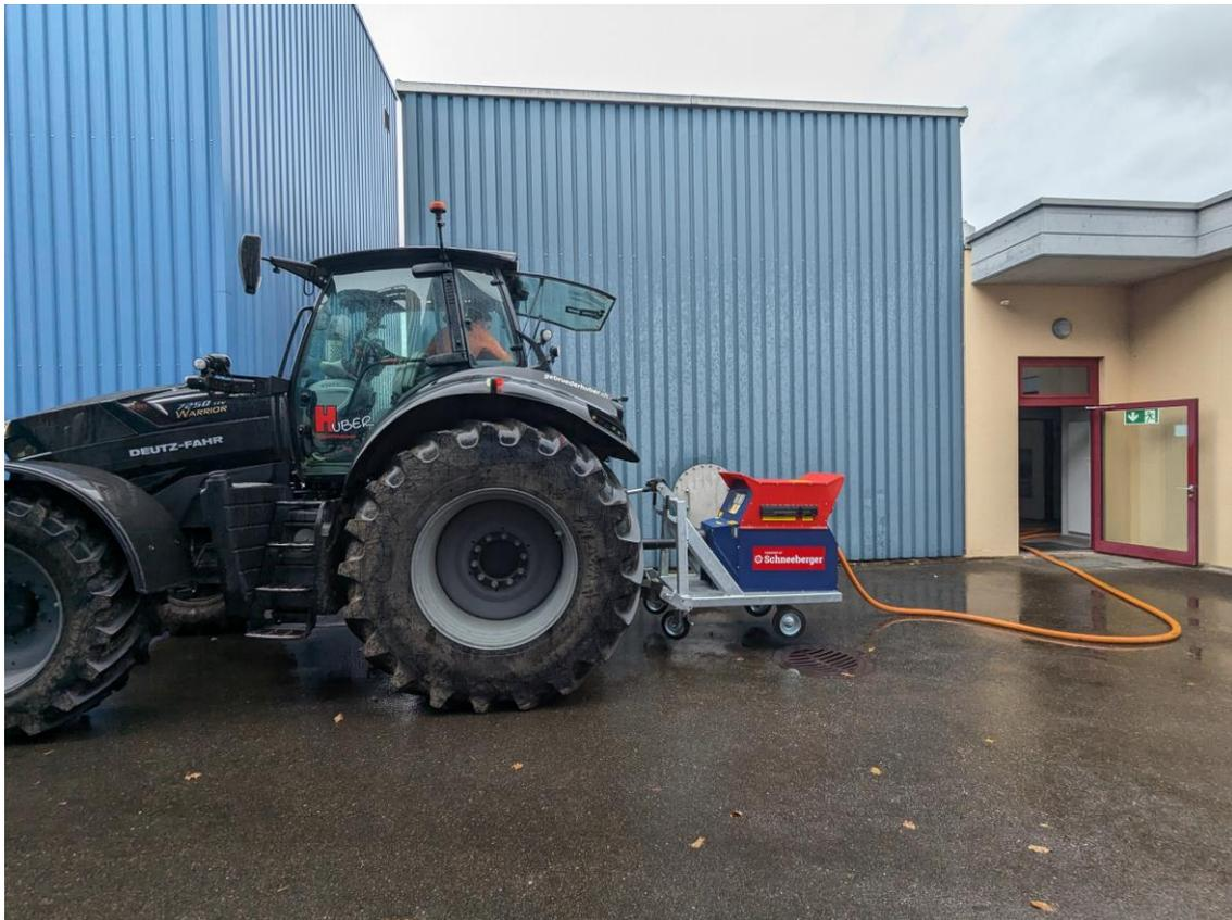
Notstromtest mit Zapfwellengenerator (Foto M. Stutz HBT)
