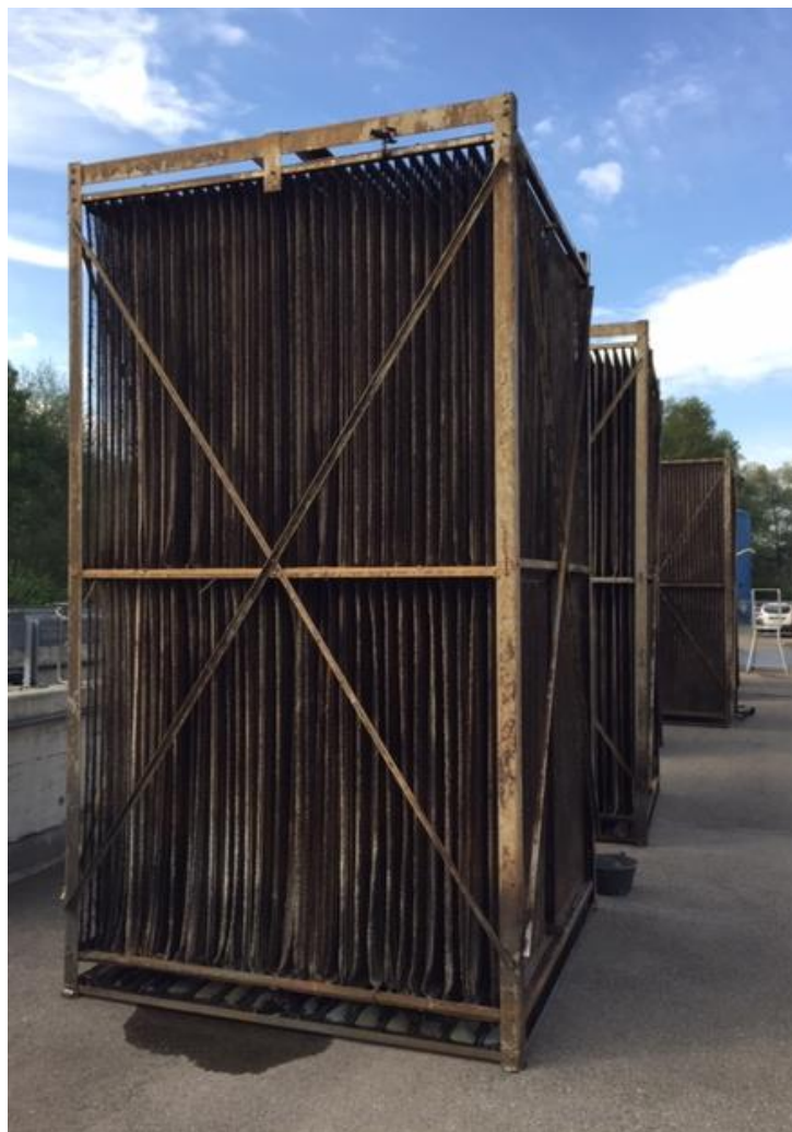
Trägermodul mit Textiltüchern aus dem Biologiebecken, besetzt mit Mikroorganismen
